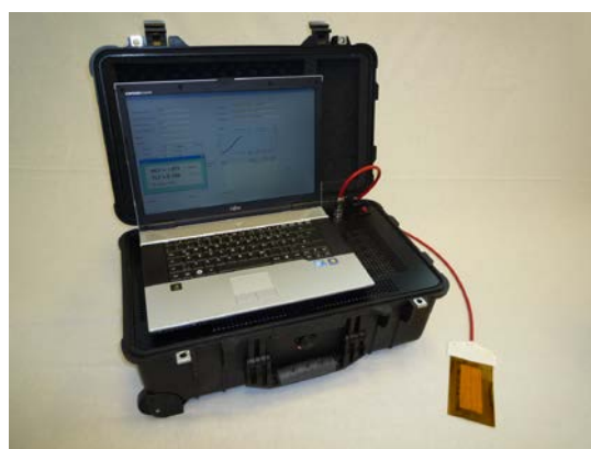
Systemkomponenten: Auswerteeinheit, Konstantstromquelle mit Messfunktion, Heizfoliensensor
